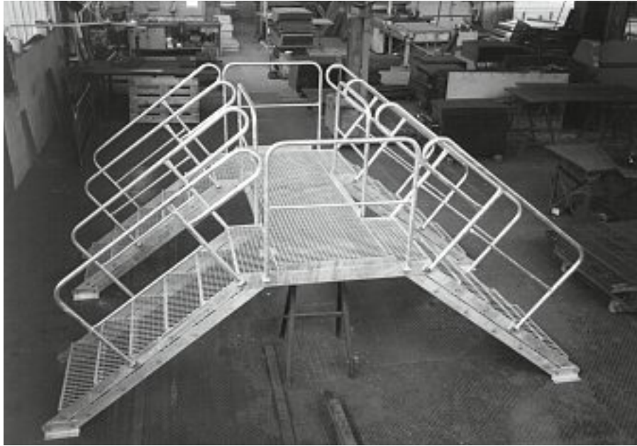
Feuerverzinkter 4läufiger Übergang nach der Abnahme durch die Endkontrolle. Hot galvanized 4-way cross-over-stair after check up in the final examination. Passerelle galvanisée quadruple apres reception.
